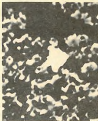
18a. ábra. (Fe, Co, Ni)-szulfid érchintés. Kompozíciós elektronkép, Z 6 jelű minta.
